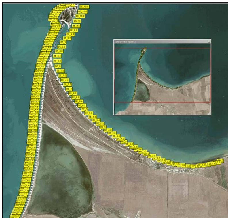
Рис. 2.2 – Система виртуальных опорных точек для Бакальской косы
